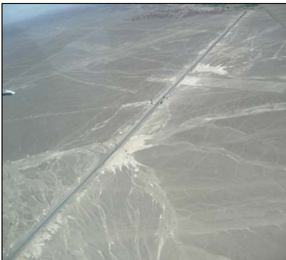
Lugar de la carretera Panamericana en donde se reproso el flujo, desbordándola e inundando parte de las figuras “El Árbol y “La Mano”. Obsérvese los represamientos en el cambio de coloración.
