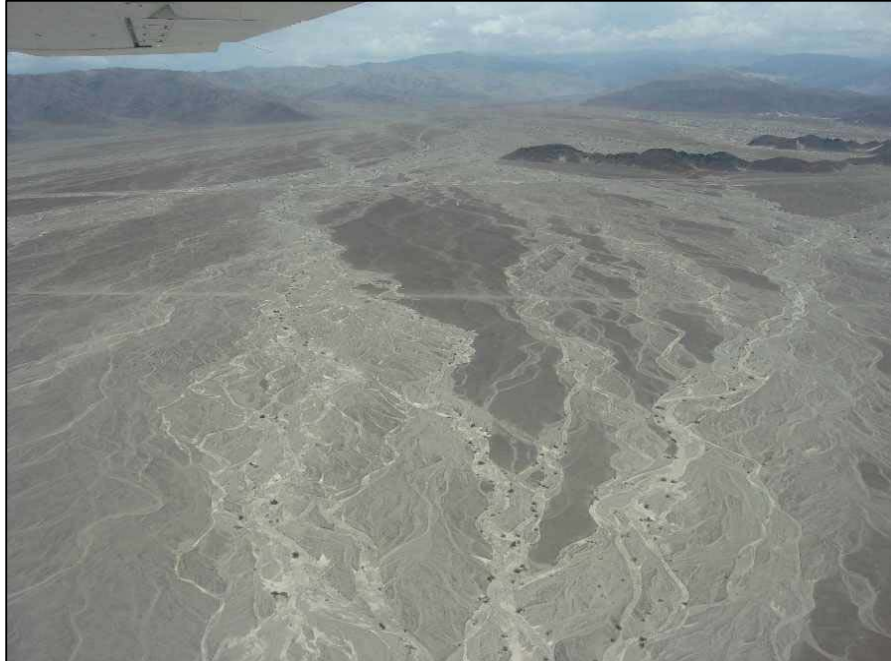
Quebrada Las Animas , a 500 m aguas arriba de la carretera, se ubican cursos de 10 a 15 m. de ancho y 0.50 a 0.70 m. de profundidad, conformado por gravas arenosas, cantos y bolones y mantos de arena limosa.
