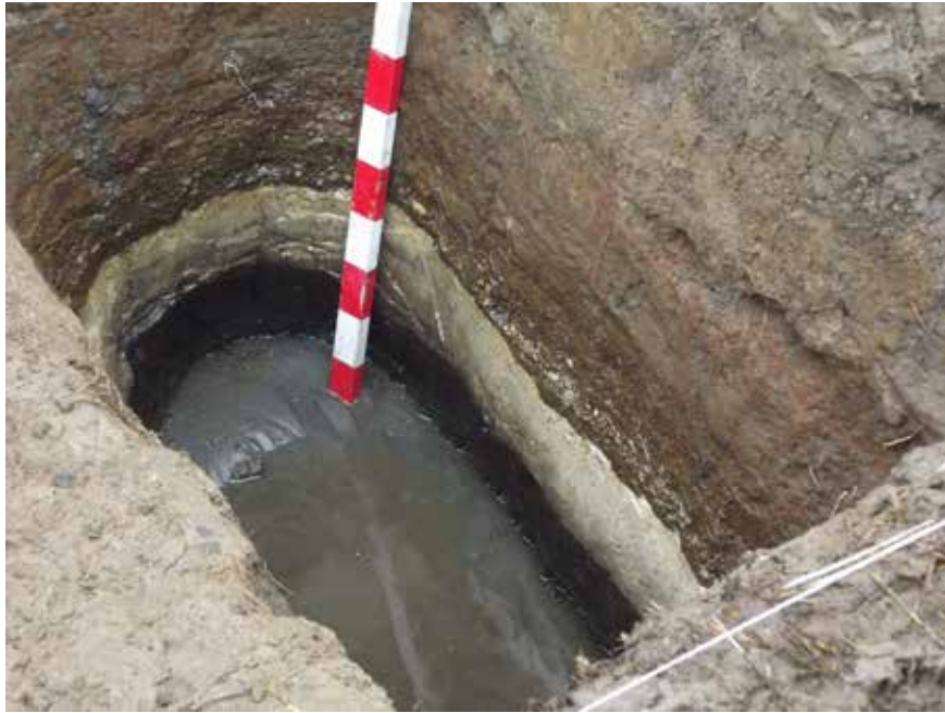
Pozo N° 11. Se observa las diferentes intercalaciones de arenas y limos propios de una sedimentación lacustre
