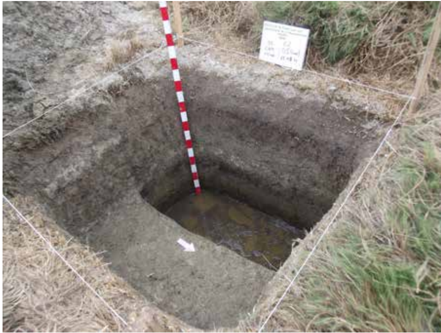
Excavación final del pozo N° 2. Se puede observar los diferentes niveles estratigráficos propios de una sedimentación lacustre de ambiente restringido
