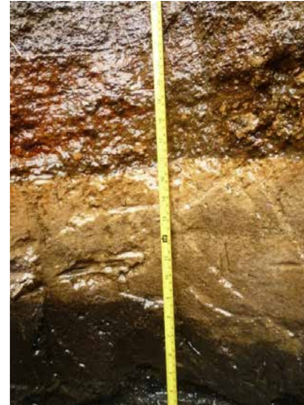
Pozo N° 11. Se observa un nivel gris oscuro y en la parte superior se puede ver arenas con restos de arcillas de niveles inferiores
