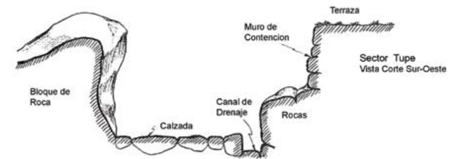
Figura 62. Gráfico de una calzada empedrada con canal de drenaje en un tramo del camino en Tupe, Yauyos, Lima (dibujado por J. Arana).
