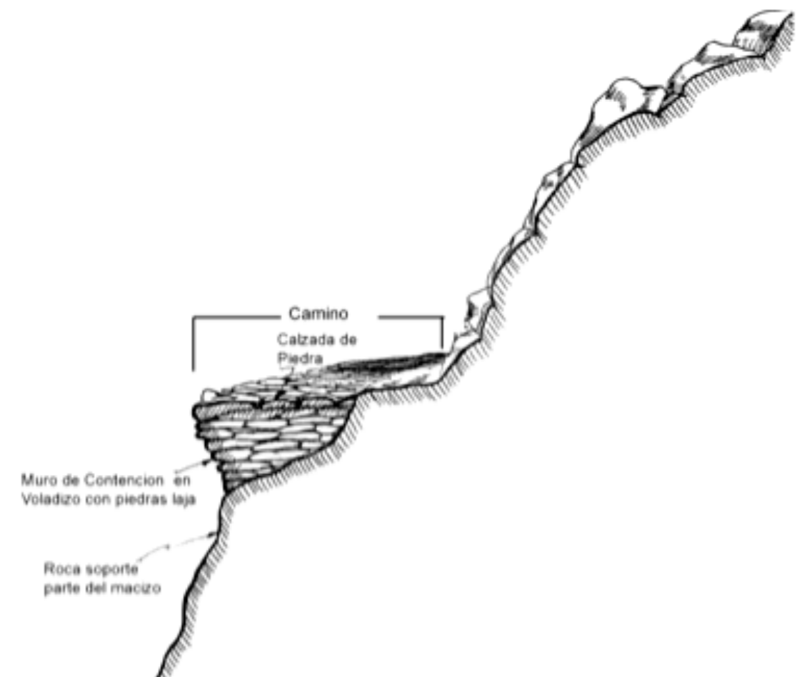
Figura 59. Calzada con muro de sostenimiento de plataforma en un tramo del camino Tupe - Catahuasi, Lima (dibujada por J. Arana).
