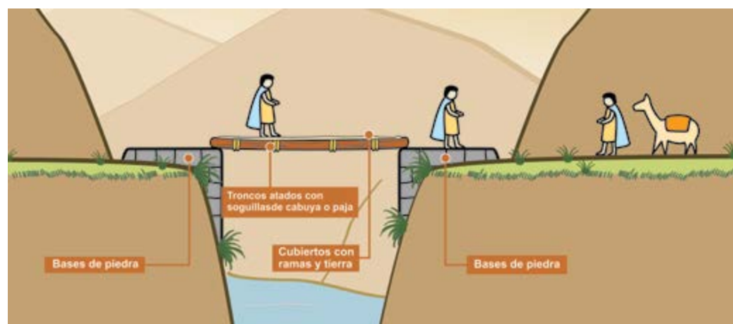
Figura 21. Gráfico de un puente de troncos (elaborado por G. Bedoya).
