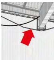
Conexiones precarias con cableado aéreo, sin supervisión técnica.
