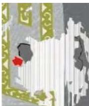
**Despredimiento de la capa de pintura o el revestimiento.**
